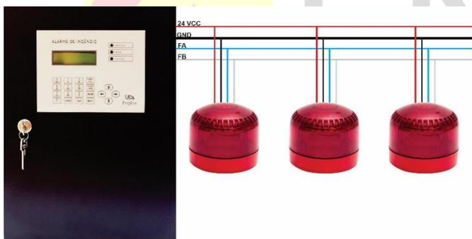
5.3. Configurar a central de alarme para em modo de endereçamento de dispositivos, de acordo o manual do equipamento (GF 125 ou GF-PRO 250), fechar um curto-circuito nos terminais de programação com o jumper. Os LED'S da sirene audiovisual irão piscar, indicando que ele está em modo de configuração. Após atribuir o endereço desejado, retire o jumper dos terminais de programação para que a sirene retorne ao estado inicial e saia do modo de configuração.
